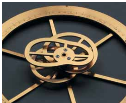
Roue annuelle avec cames d'équation du temps, de lever et de coucher de soleil (avant/après).
