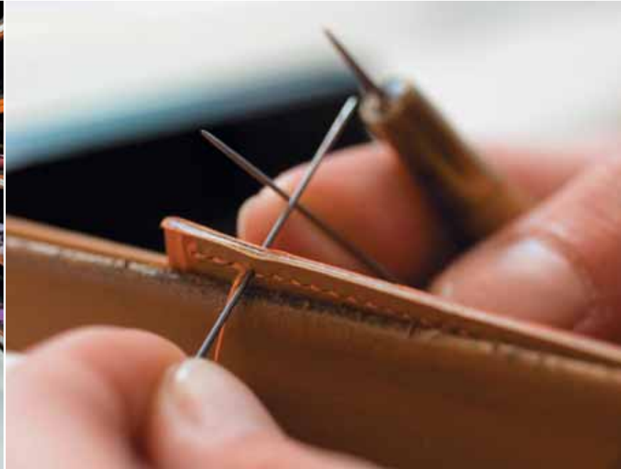
Bei den Nadelstäben und der Schliesse sind die Anfangsriegel zur Verstärkung doppelt genäht.
