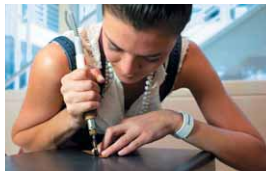
Durch das Ziehen wird der Bändel geglättet, der überflüssige Leim entfernt und die Naht betont.
