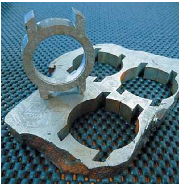
Mit seiner Maschine mit CNC-Steuerung hat Antoine Prezioso ein Gehäuse aus einem Meteoritenstück geschritten.
