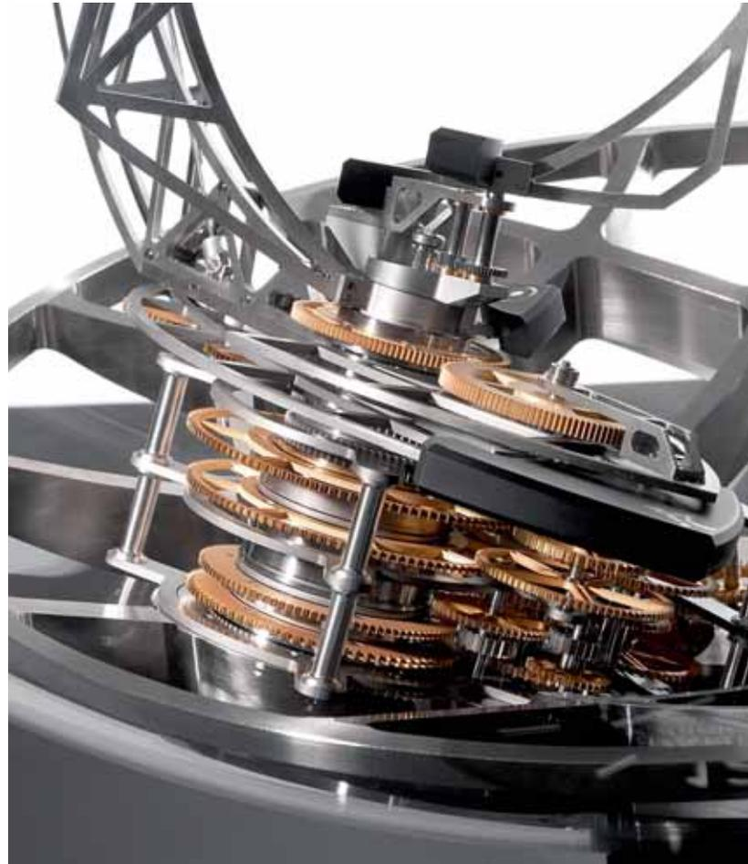
Le Jupiterium de Panerai est actionné par un mouvement de chronomètre. La structure portante pour les planètes et l'engrenage est fabriquée en titane léger.
