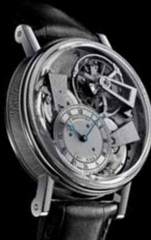
**Breguet** Après l'introduction dès 2006 d'un spiral plat en silicium dans différents modèles, voici pour la première fois un spiral à courbe terminale Breguet équipant le mouvement à remontage manuel avec tourbillon et transmission fusée-chaîne de ce nouveau modèle Tradition 7047. Indication de la réserve de marche de 50 h sur le tambour du barillet à 10 h. Boîtier platine de 41 mm. Cadran or. Fond ouvert. 184 600 CHF
