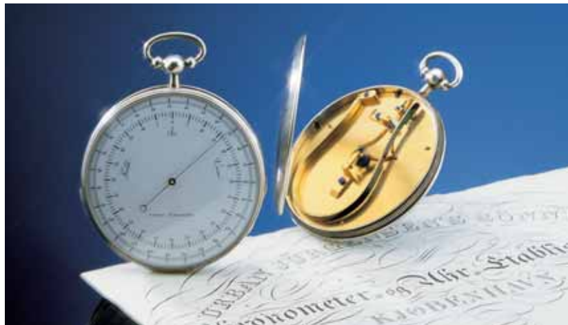
Bimetall-Thermometer von Jürgensen in einem Uhrengehäuse. Die ersten entstanden in den Houriet-Werkstätten.
