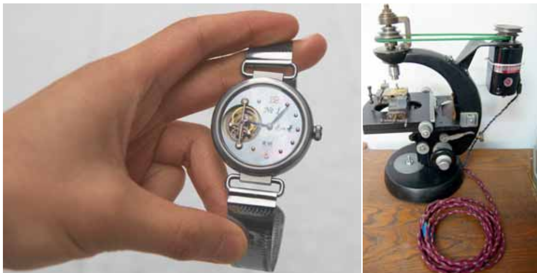
Die erste Uhr, die er vollständig selbst hergestellt hat, mit Tourbillon, Titangehäuse und Blecharmband. Eine raffinierte Maschine: Mikroskop mit angebauter Fräse.
