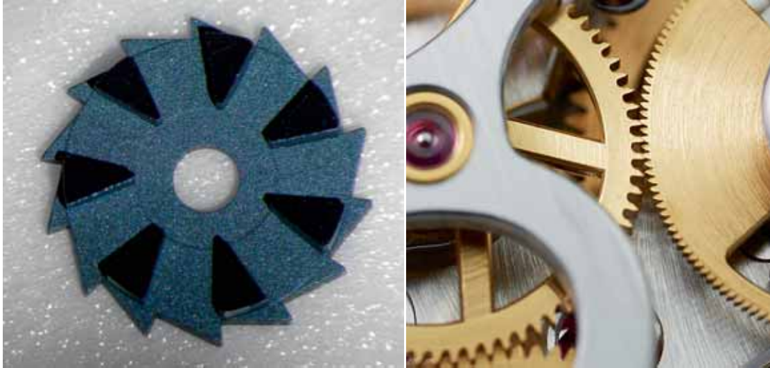
Säulenrad LaJoux-Perret, poliert und sandgestrahlt. Horizontale Kupplung Patek Philippe.
