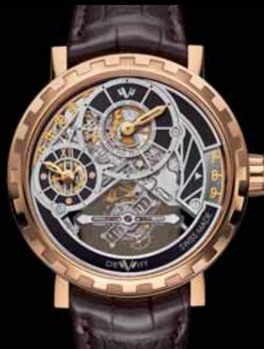
**DeWitt** Die Academia Grand Tourbillon zeigt auf zwei Zählern bei 9 h und bei 12 h die springenden Stunden und die springenden Minuten an. Antrieb durch eine auf dem Zifferblatt sichtbare Zahnstange. Datum bei 3 h. Manufakturkaliber mit Straumannspirale, Handaufzug. 65 h Gangreserve. 46 mm grosses Roségoldgehäuse. Geschraubter Sichtboden mit Tag/Nachtanzeige. Alligatorarmband, Schmetterlingsfallschliesse. 99 Stück. CHF 275000
