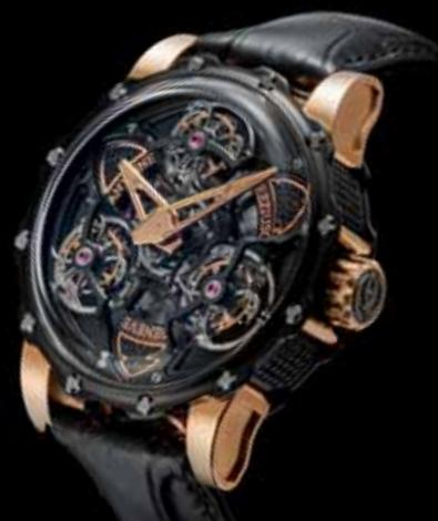
**Antoine Prezioso** Le Tourbillon of Tourbillons est muni d'un calibre à remontage manuel à 3 tourbillons d'un tour/min reliés par un triple différentiel planétaire de 65 pièces positionné sur un plateau tournant en 10 min. Synchronisation des 3 organes régulateurs par résonance. Double barillet. Autonomie de 48 h. Boîtier en acier, or et titane de 45 mm. Fond saphir. Etanche à 50 m. Bracelet crocodile. 480000 CHF
