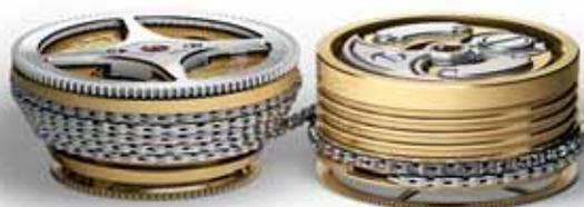
Page de gauche : le calibre FB-T.FC vu sans ses ponts. Les piliers apparaissent nettement, mais aussi le fait que la régulation de l'énergie (chaîne et fusée, tourbillon) occupe l'essentiel du volume.
