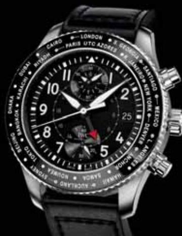
**IWC** Die Fliegeruhr Timezoner enthält ein neues Kaliber mit automatischem Aufzug. Es kombiniert die Chronographenfunktion mit einer über die Lunette wählbaren zweiten Zeitzone. Anzeige von Tag und Nacht über 24-Stundenzeiger. Wahl der gewünschten Zeitzone über drehbare und rastende Lynette mit aufgedruckten Weltstädten. 68 h Gangautonomie. Wasserdicht bis 60 m. 45 mm grosses Stahlgehäuse. Boden mit Gravur. Lederarmband. CHF 13000
