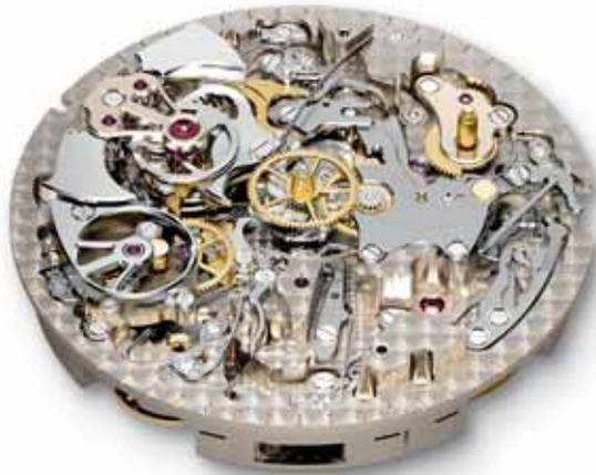
Le mécanisme de répétition minutes est concentré entre 8 et 11 h.
